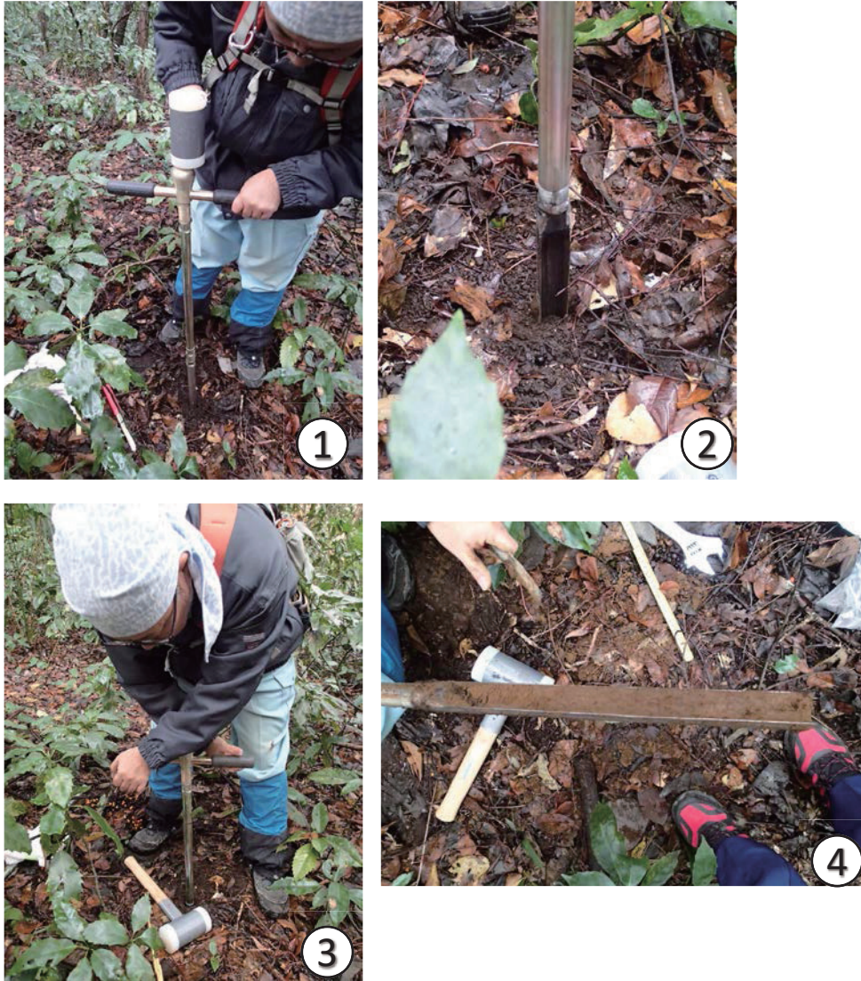
写真2. ルートオーガーによる土壌試料掘削工程.
