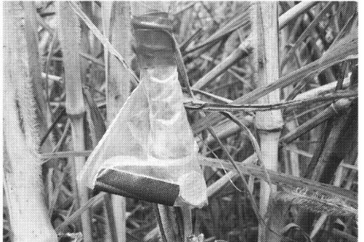
付図 6. 巣外に設置した温度データロガー.
