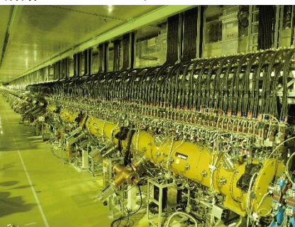
⑥J-PARC直線型加速器ドリフトチューブリニアック 写真提供: J-PARCセンター
