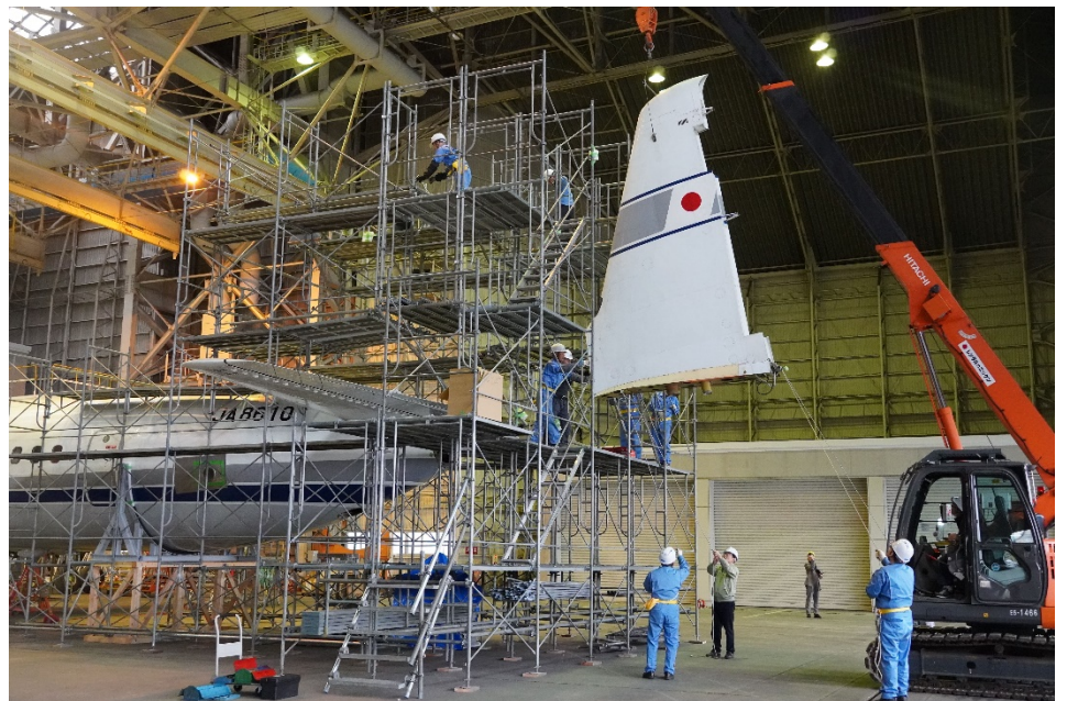
2019/11/26 の垂直尾翼取り外し作業
