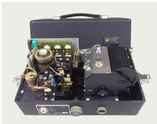
アナログ式強震計「SMA-1A」（アメリカ、Kinematics社製）
