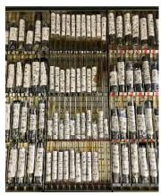
クリープ破断試験片
