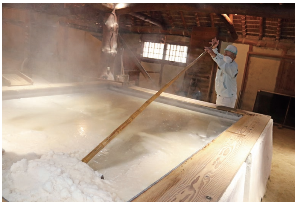
平釜でかん水を煮詰め、塩の結晶を取り出す様子
