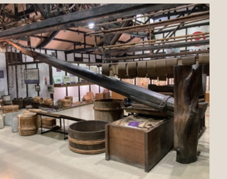
テコの原理でもろみを搾った昔の圧搾機
