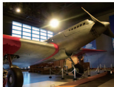
航研機（復元機）。風防がなく離発着時はパイロットが窓から顔を出すなど機能に徹した独特の機体
