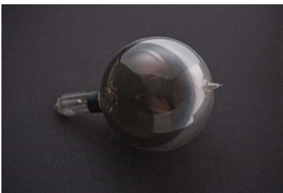
④ 高柳式テレビジョン装置の光電管 (所蔵：国立科学博物館)
