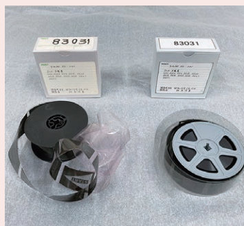
劣化したマイクロフィルム(左) 複製したフィルム(右)
