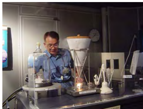
液体窒素に冷やされて空気中の酸素が液化した後、火を近づけると燃えることがわかる装置
