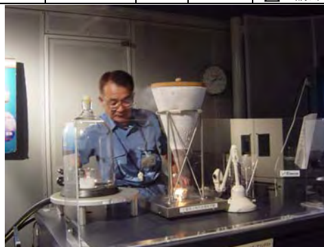
液体窒素に冷やされて空気中の酸素が液化した後、火を近づけると燃えることがわかる装置
