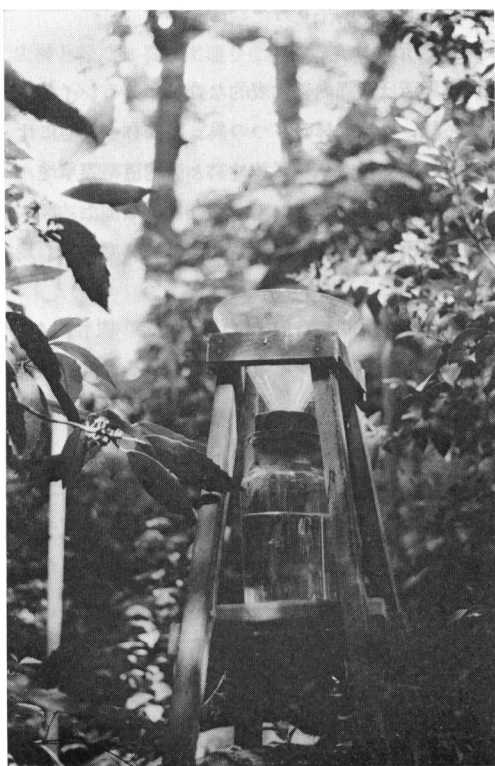
図 4 降下媒塵捕集ビン設置状況（シイ林内）
