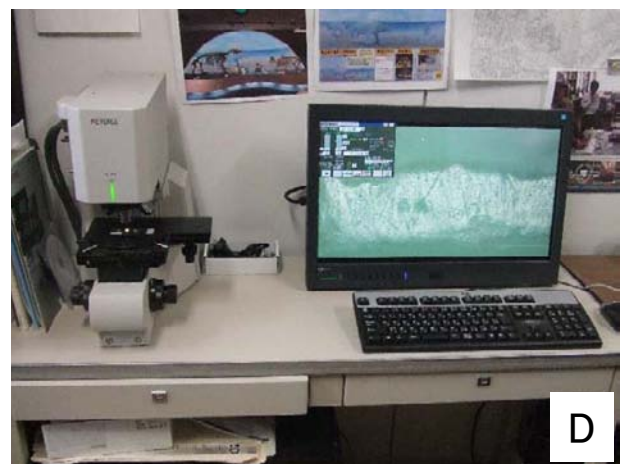
図4. 資料の型取りの様子。A, 歯の表面を100%アセトンで洗浄。B, 歯科用印象材を塗布。C, 作製した歯のモールド。D, 共焦点レーザ顕微鏡 (VK-8500) のステージ上にモールドを設置して表面形状を計測。
