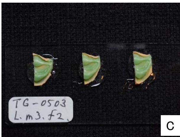
図4. 資料の型取りの様子。A, 歯の表面を100%アセトンで洗浄。B, 歯科用印象材を塗布。C, 作製した歯のモールド。D, 共焦点レーザ顕微鏡 (VK-8500) のステージ上にモールドを設置して表面形状を計測。
