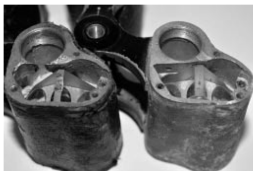
図6 鏡体接眼部取付ネジ部分. 左がN氏所蔵機, 右は寄贈機.
