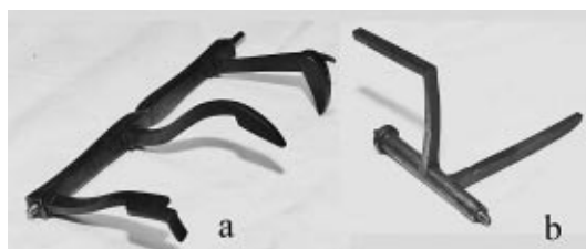
図15. 時打起動・継続・停止制御梃子（「三つ枝金」と呼ばれる）および時打動作伝達梃子（「二つ枝金」呼ばれる）
