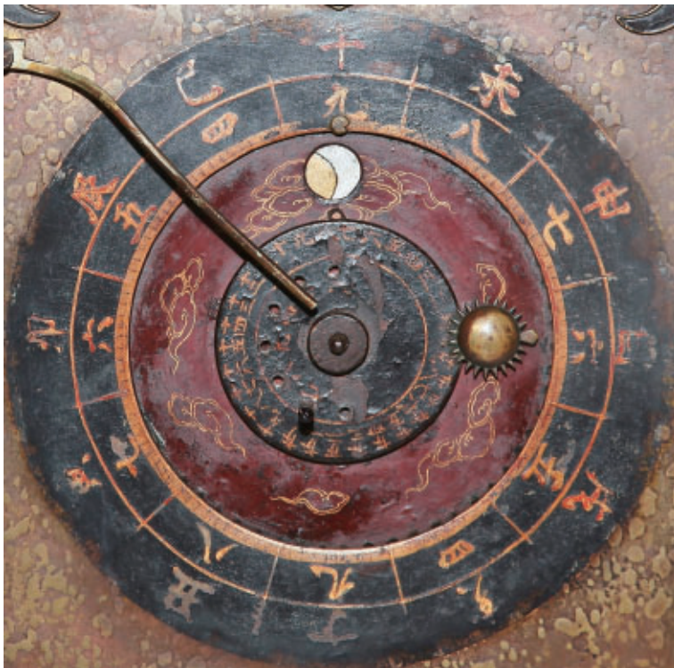
図20. 時刻目盛および天文表示：太陽針は中央の旧暦日付目盛盤に固定されている。丸穴に月位相が表示され、月針の役割を果たす。太陽針と月針は天球上の概ねの位置を示し、月針は旧暦日付目盛盤の周りを1朔望月で1周し旧暦日付を知ることができる。
