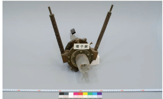
図8 宮本研で開発された電子銃
