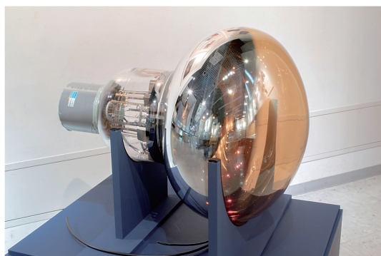
図2 カムランドで再利用された初代カミオカンデの光電子増倍管
