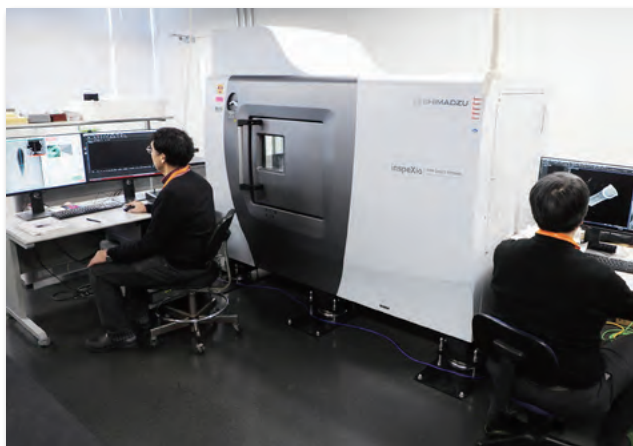
マイクロCTを用いた生物試料の3D形状測定 3D measurements on biological specimens using microCT
