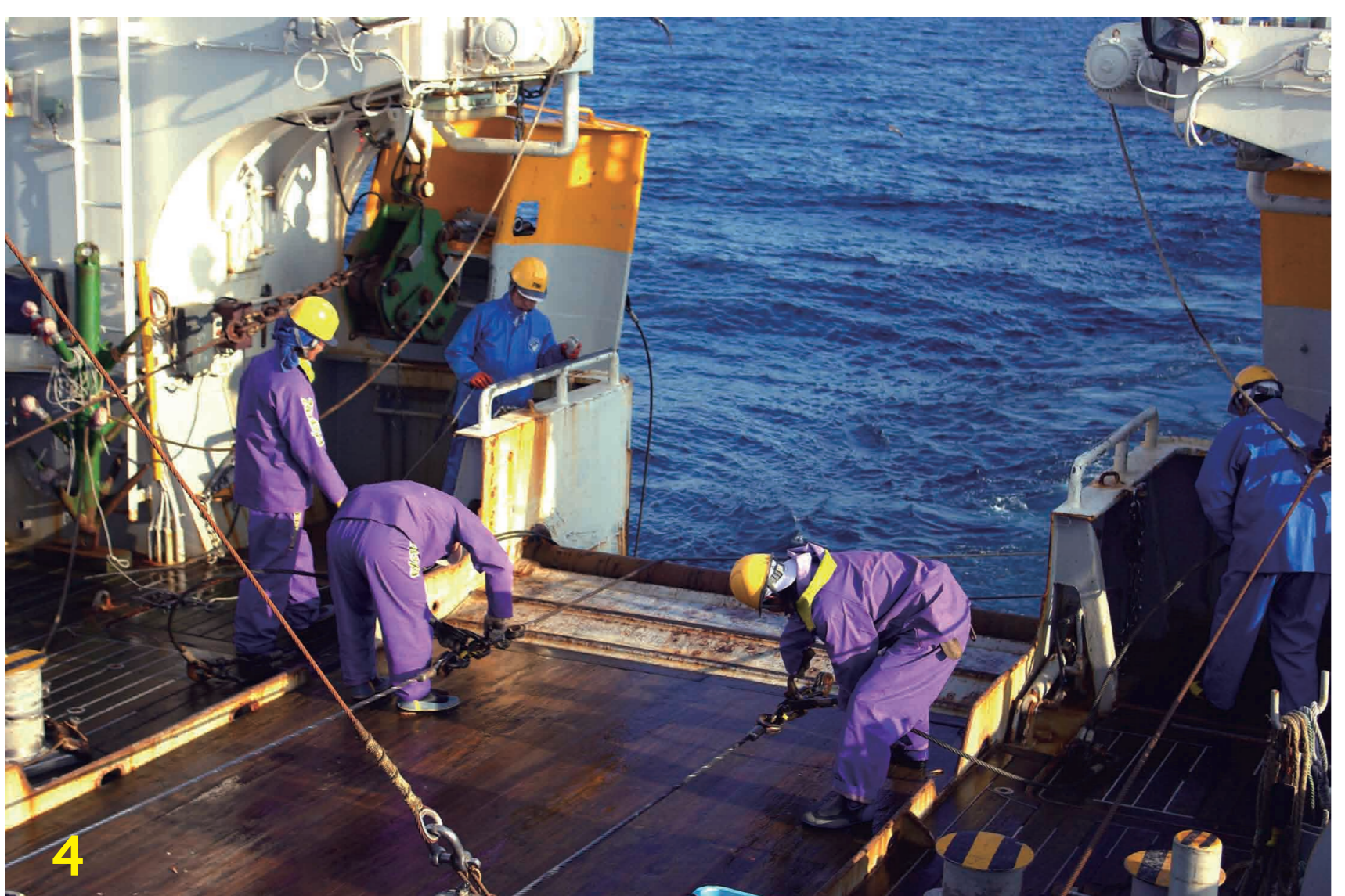
4. オッターボード(左右の舷側につり下げられた巨大な鉄板)が揚収され、ワープとウィンチワイヤーとを付け替える。船の作業は常に危険が伴う。
