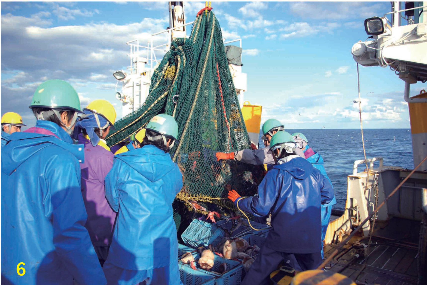
6. トロール網の末端が揚収されて揚網終了。クレーンで吊り上げて漁獲物をカゴに移すのだが、..
