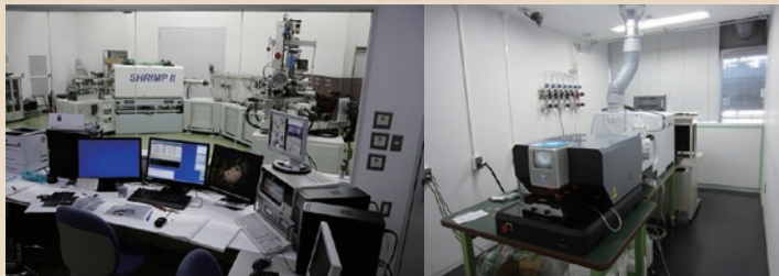
国立極地研究所のSHRIMP(高感度高分解能イオンプローブ:左)と当館のLA-ICP-MS(レーザーアブレーション誘導結合プラズマ質量分析計:右)。共に、ジルコンのウラン-鉛年代を測定するのに有用な機器である。
