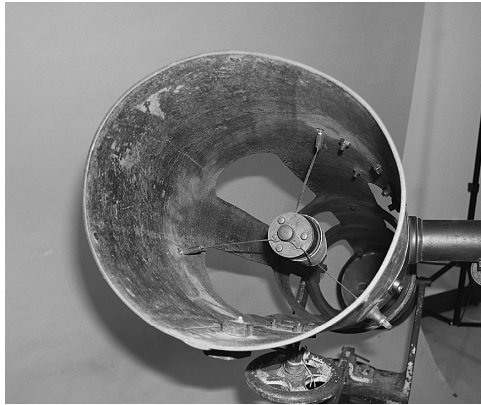
図9. 斜鏡支持金具（写真中央部）
