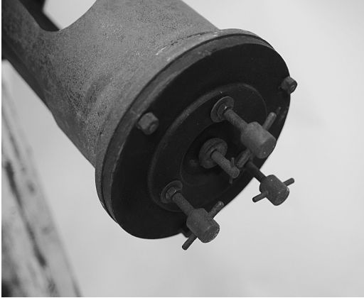
図8. 鏡筒底面と光軸調整ネジ
