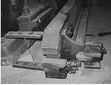
図9. 木製ガイドレールに対応した非常止め装置
