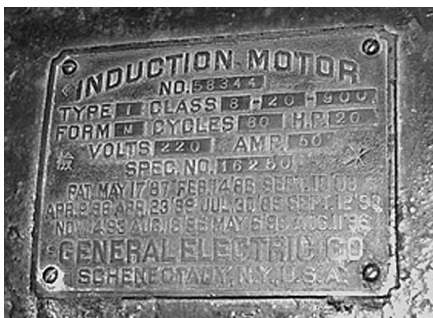
図7. 電動機の銘板
