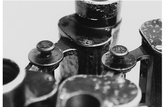
図9 「森式双眼鏡」(左)とツァイス製 Feld-stecker6×18 (右)の緊定金具
