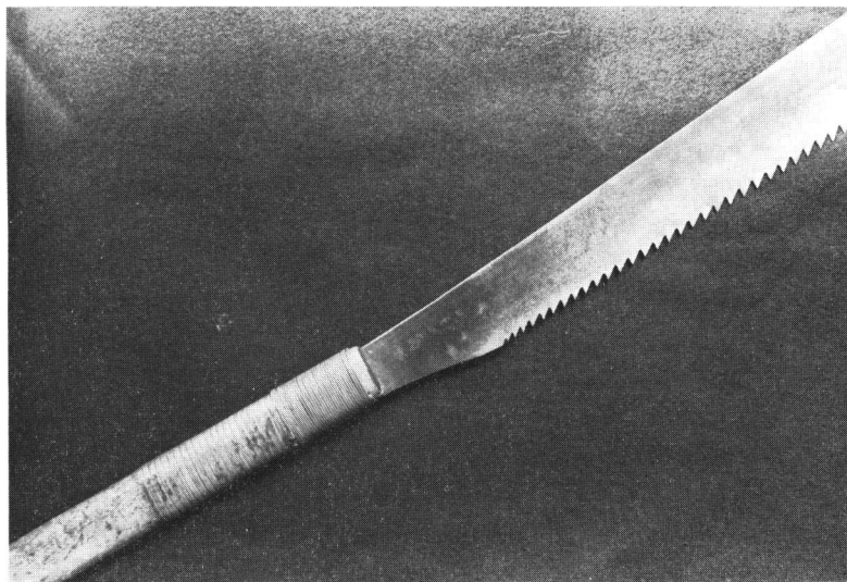
写真 1 縦挽鋸 三代目中や伊ノ助作 1 尺
