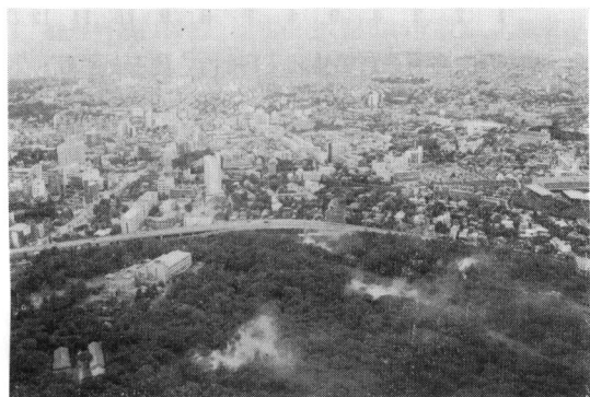
写真4 発煙による気流調査
