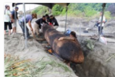
⑥丸木舟スギメ2表面を焦がす作業。この後に内面と外面を石などで磨いて滑らかにする。
