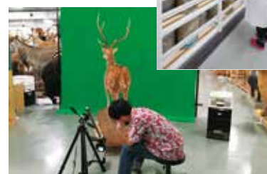
フォトグラメトリーによる 3D データの取得 Capturing images for 3D model reconstruction with photogrammetry
