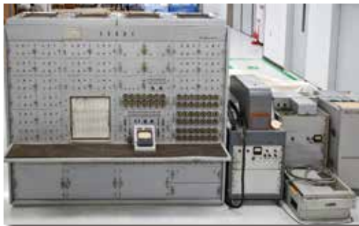
強震応答解析用アナログ計算機 "SERAC" (情報処理技術遺産) Strong Earthquake Response Analysis Computer (SERAC)
