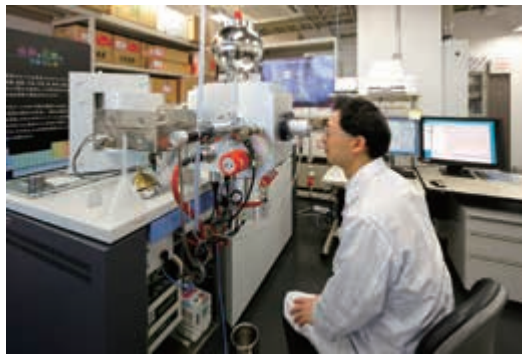
質量分析計による隕石の同位体分析 Isotope analysis of meteorites by a mass spectrometer
